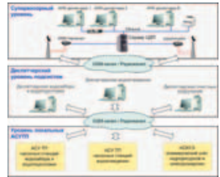
Рис. 2. Структурная схема комплексной автоматизации водоканала
