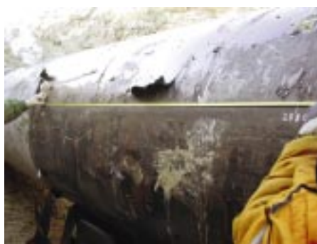
Рис. 4. Потеря устойчивости газопровода (овальность трубы)
