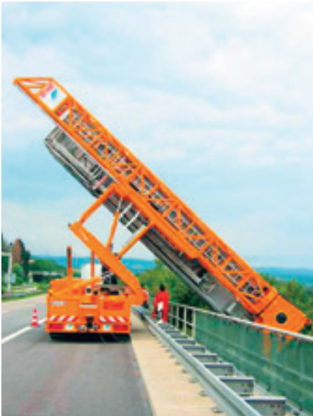
MBI 210-2S с платформой грузоподъемностью 1 т, глубина опускания стрелы 11 м
