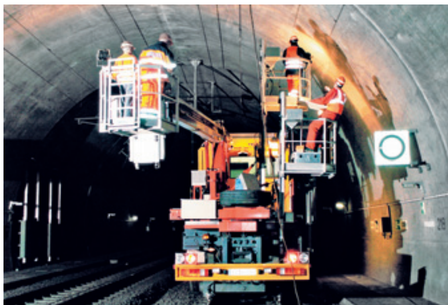
UA 1600 T — мобильная система для ремонта и обслуживания автомобильных и железнодорожных тоннелей с тремя рабочими
