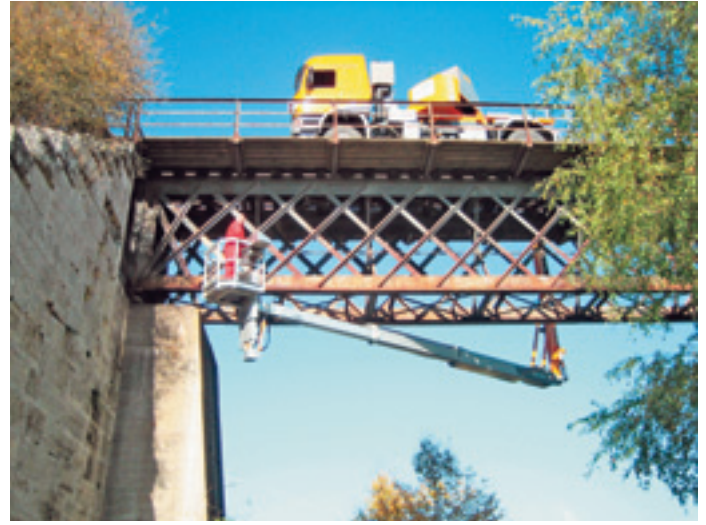
MBL 1200 T — модель с корзиной грузоподъемностью 250 кг, рабочая высота 14 м, глубина опускания 15 м
