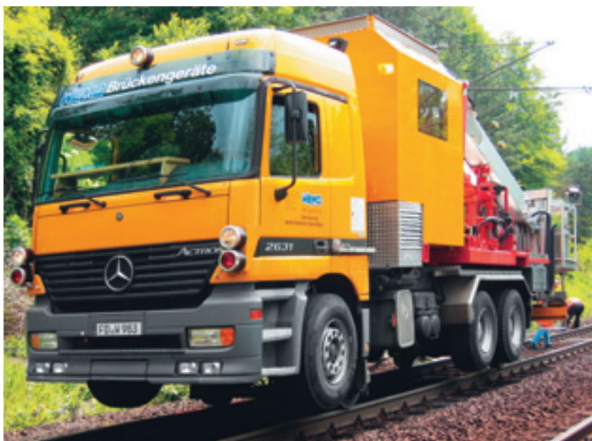
Мобильная система для ремонта тоннелей с гибридным шасси
