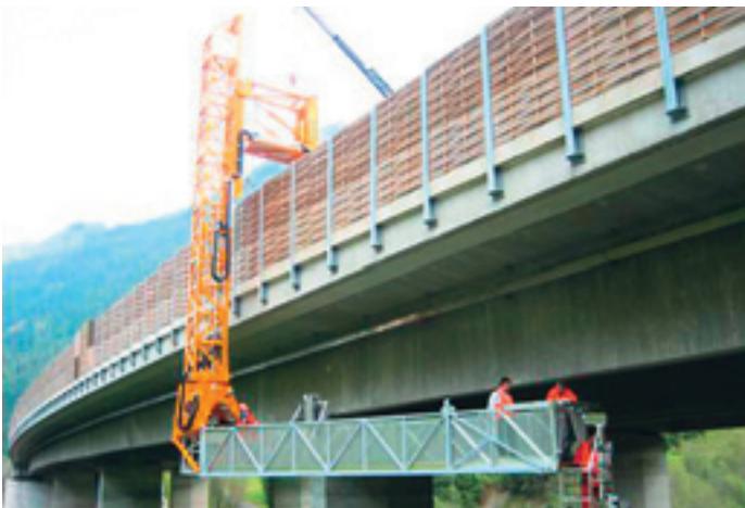
MBI 180-1,7S с платформой грузоподъемностью 800 кг, глубина опускания стрелы 10,5 м
