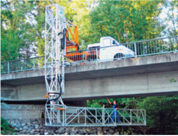
MOOG 70-1S с платформой грузоподъемностью 400 кг, глубина опускания стрелы 5,5 м
